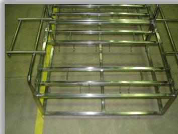
Os suportes para os blocos de válvulas usinados poderão ser dedicados e são construídos em inox AISI 304 e encaixados no Frame que se trata de um quadro dedicado para o sistema de transporte automatizado da Lavadora. A configuração dos suportes está diretamente ligada ao volume de produção o qual poderá ser adequado em função dos tempos de ciclo do processo.
