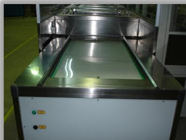
Esteiras Transportadoras (in/out = carga/descarga) são construídas em inox com fechamento em PP e utilizam correntes transportadoras tracionadas pôr motoredutores internos marca Bonfiglioli.
